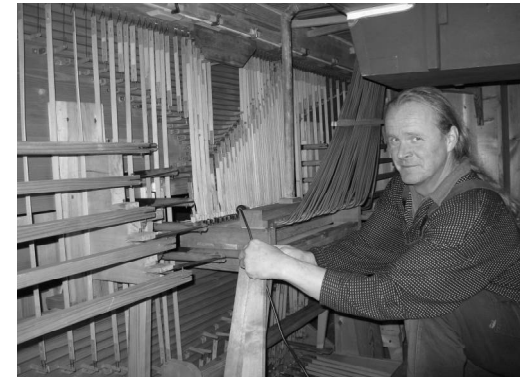
Orgelbauer Remmler hat alle Windkanäle aus Holz abgedichtet
